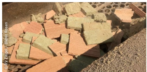
Mauerziegel mit Dämmstofffüllung aus Mineralwolle-Stecklingen. Die Füllungen sind durch Formschluss in den Kammern und Lochungen fixiert. Dadurch lassen sich im Recycling leicht Keramik und Dämmstoff trennen.
