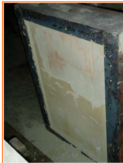
Bild 2: Beflammte Seite des Prüfkörpers nach 92 Minuten Feuerbeanspruchung
