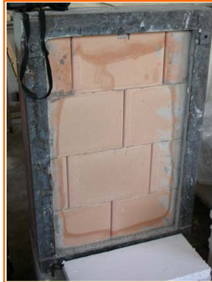
Bild 1: Unbeflammte Seite des Kleinprüfkörpers
