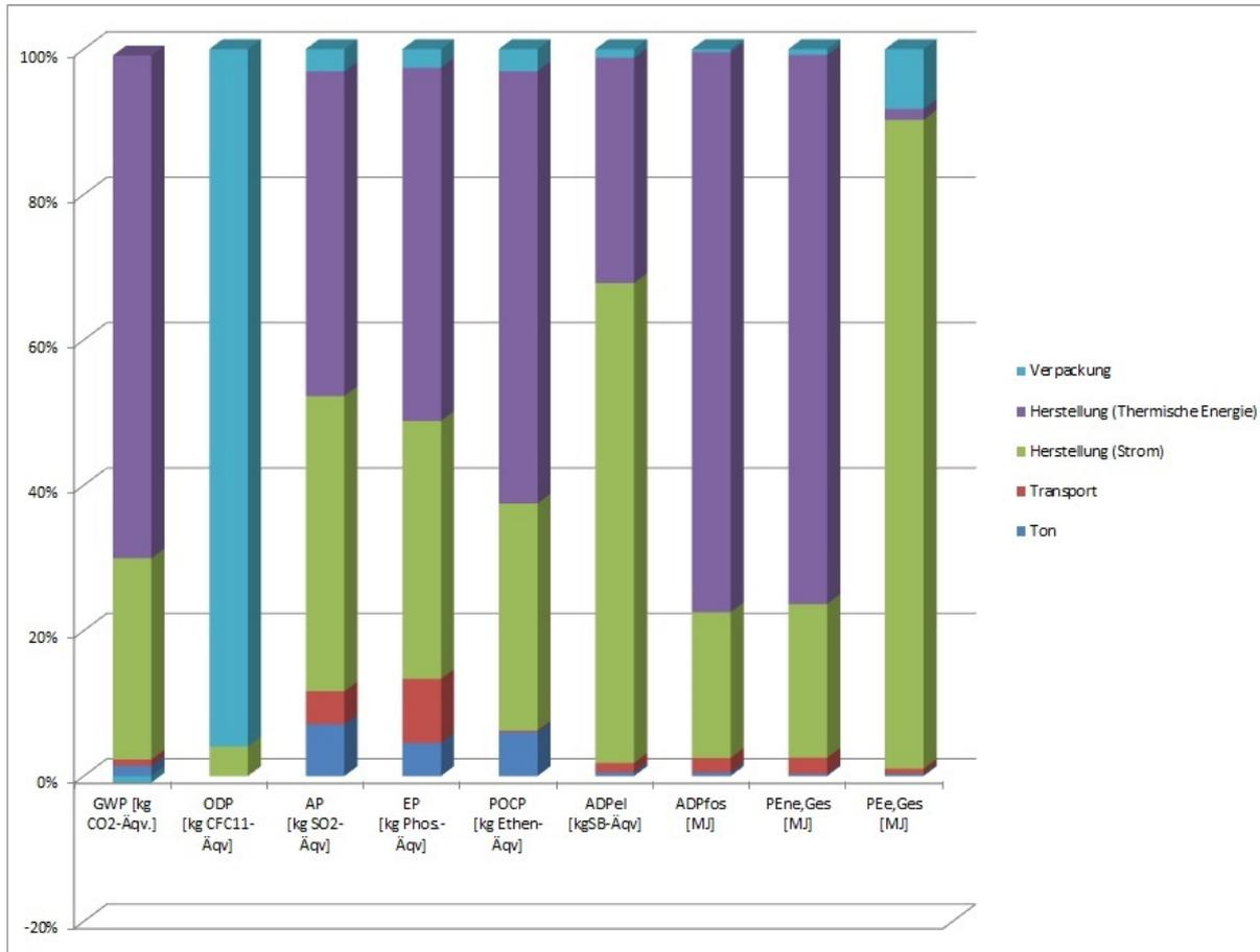
Die Auswertung der ökobilanziellen Ergebnisse der Dachziegel zeigt auf, dass die Umweltwirkungen in allen Umweltkategorien speziell vom Energieverbrauch während des Herstellungsprozesses (Strom und thermische Energie aus Erdgas) im Werk dominiert werden.
