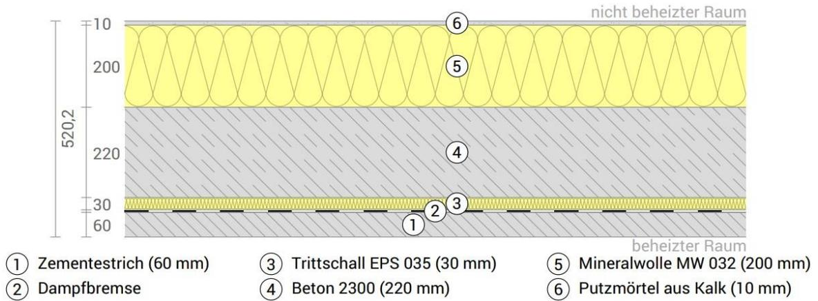
Abb. 3-5: Decke über Kellergeschoß | U-Wert 0,13 W/(m²K)
