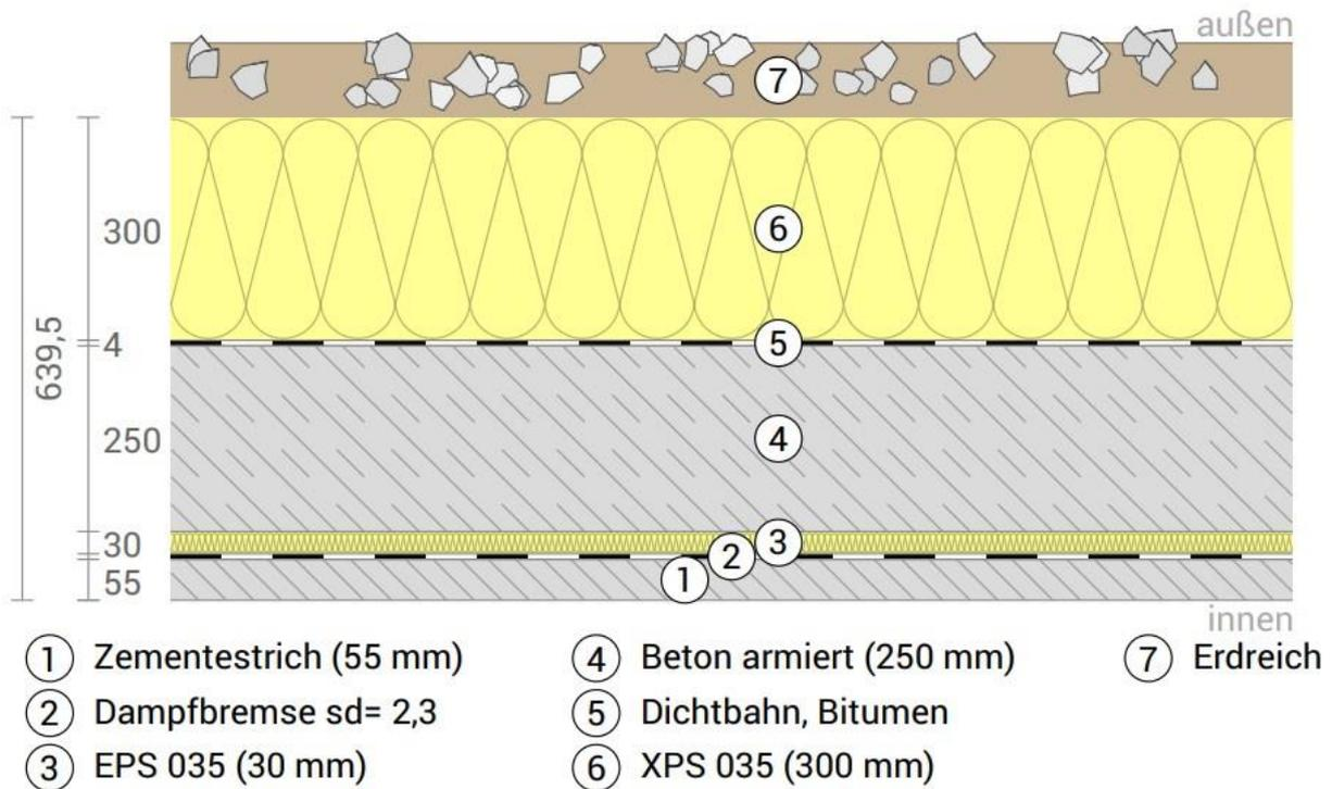
Abb. 3-3: Bodenplatte | U-Wert 0,11 W/(m²K)
