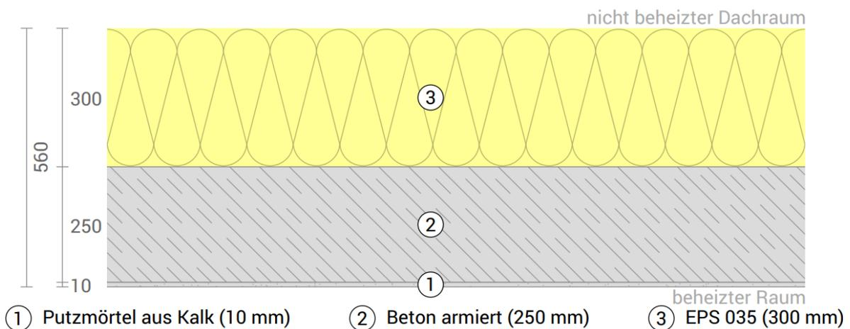
Abb. 3-7: Dachaufbau (Dämmung gegen unbeheizten Dachboden) | U-Wert 0,11 W/(m²K)
