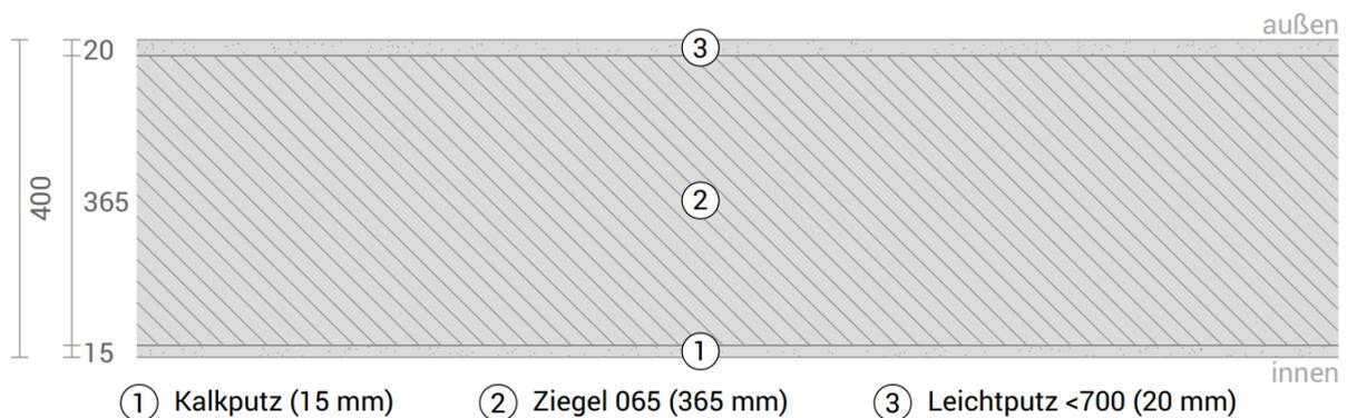
Abb. 3-2: Konfiguration Außenwand Ziegel (Dämmstoff-gefüllt) | U-Wert 0,17 W/(m<sup>2</sup>K)
