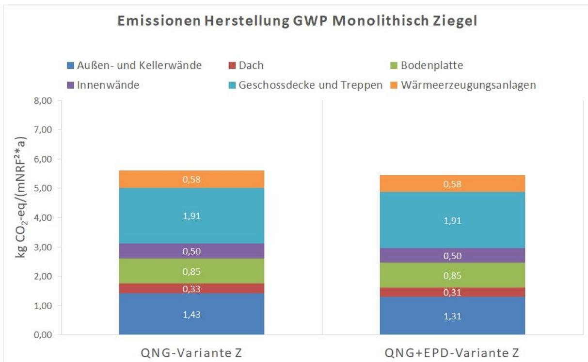
Abb. 4-2: Ergebnisse Herstellungsphase Variante Monolithisch Ziegel für CO<sub>2</sub>-Äquivalente
