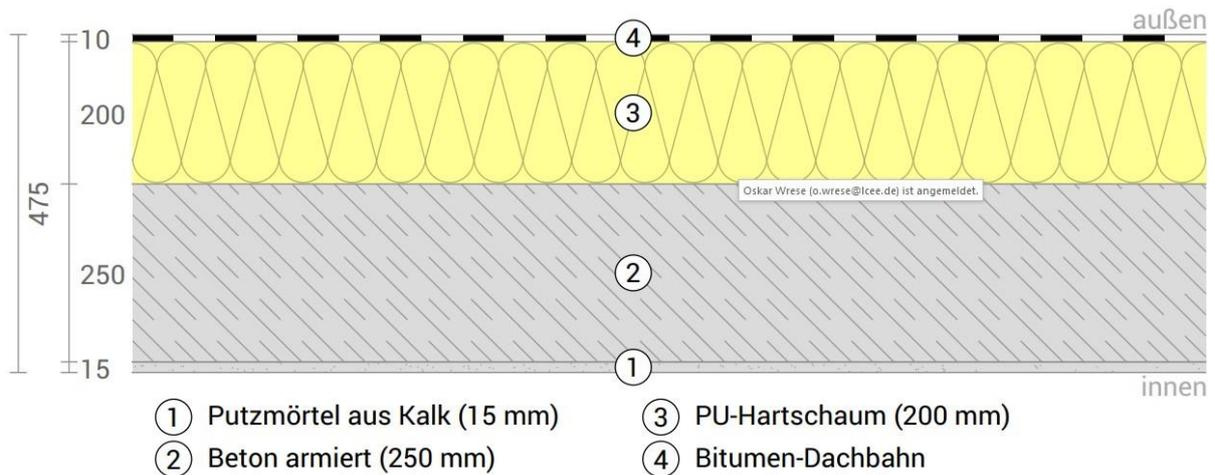
Abb. 3-6: Dachaufbau Flachdach | U-Wert 0,12 W/(m²K)
