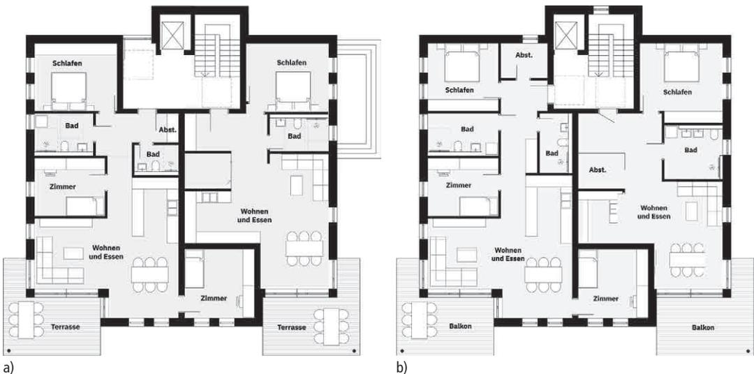
**Bild 6.** Darstellung der Grundrisse; a) Erdgeschoss und b) 1. Obergeschoss des Pilotprojekts (Bildquelle: Grimm GmbH)
